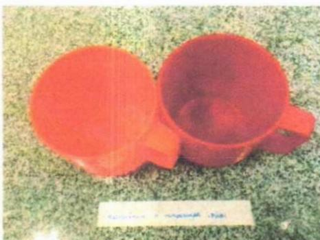
Amostra após o ensaio de Resistência a Temperatura
