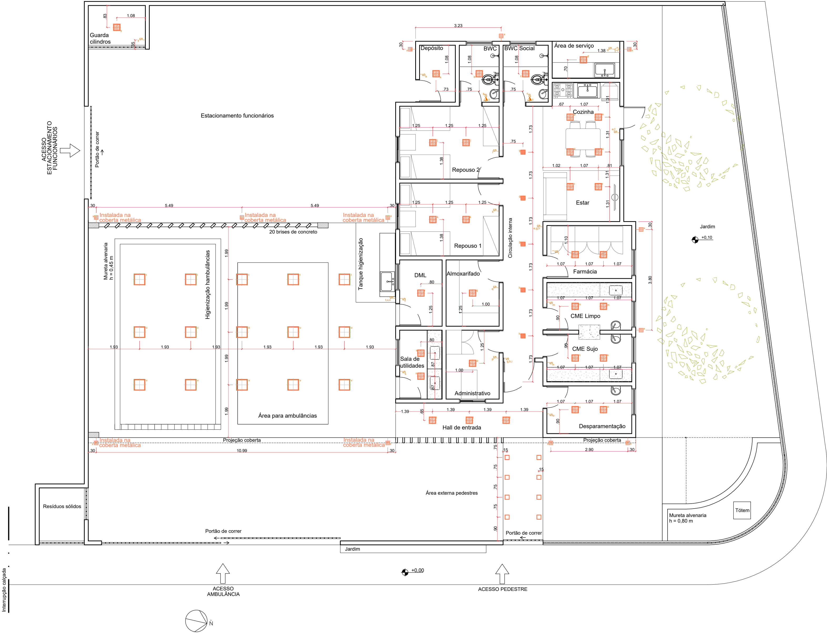
01 PLANTA BAIXA - PONTOS DE ILUMINAÇÃO ESCALA: 1/75
